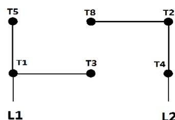
Observação: R, S e T são os fios da rede de alimentação do motor trifásico. L1 e L2 representam a alimentação do motor monofásico.
