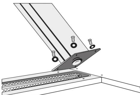
04 - Coloque a coluna sem motor sobre a base, no lado contrário ao esticador (chapa soldada na extremidade da base) mantendo-a inclinada para colocação da corrente na engrenagem. Posicione a coluna sobre os furos da base, coloque os parafusos de fixação folgados, puxe esta coluna com as mãos para a extremidade da base e aperte os parafusos.
