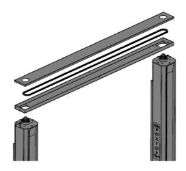
09 – Após finalizar a montagem das bases e colunas, posicione a calha de sincronismo entre as colunas movidas, conforme a figura, depois de parafusada a calha nos mancais, posicione a corrente nas engrenagens, aperte o esticador até que a corrente desencoste do fundo da calha, e de forma que aproximando os dois lados da corrente, a distância seja de 50mm, conforme especificado na etapa 05. Finalizando o procedimento, insira a tampa da calha de sincronismo.
