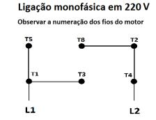
Observação: R, S e T são os fios da rede de alimentação do motor trifásico. L1 e L2 representam a alimentação do motor monofásico.
