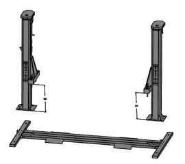
02 - Antes de colocar as colunas sobre a base verifique se os suportes dos braços estão na mesma distância da base da coluna. Puxe o suporte dos braços para o lado da base e com uma trena confira a distância, caso haja diferença, use a chave de descida manual na porca superior do fuso para regular altura.
